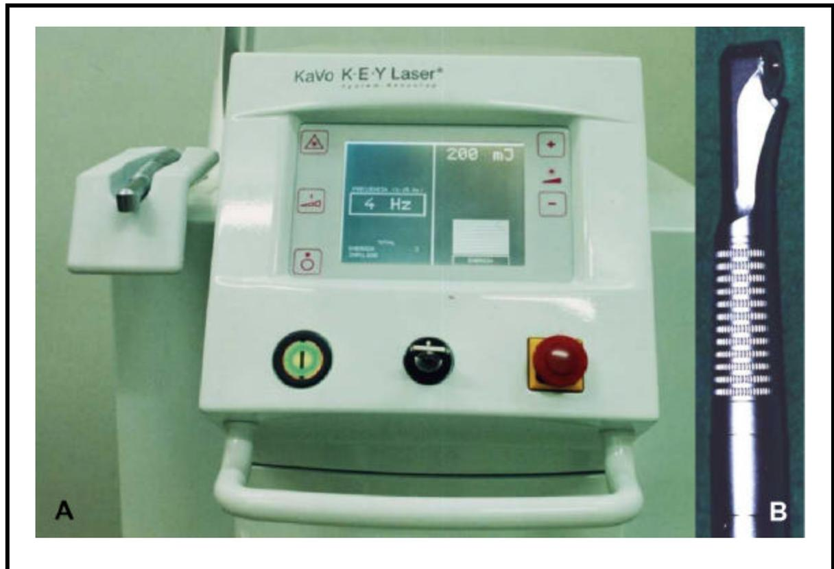
Figura 4. (A) Painel do aparelho de laser Er:YAG, KAVO KEY Laser II, mostrando os parâmetros utilizados neste estudo, (B) Peça de mão número 2051, utilizada para a irradiação dos dentes.
